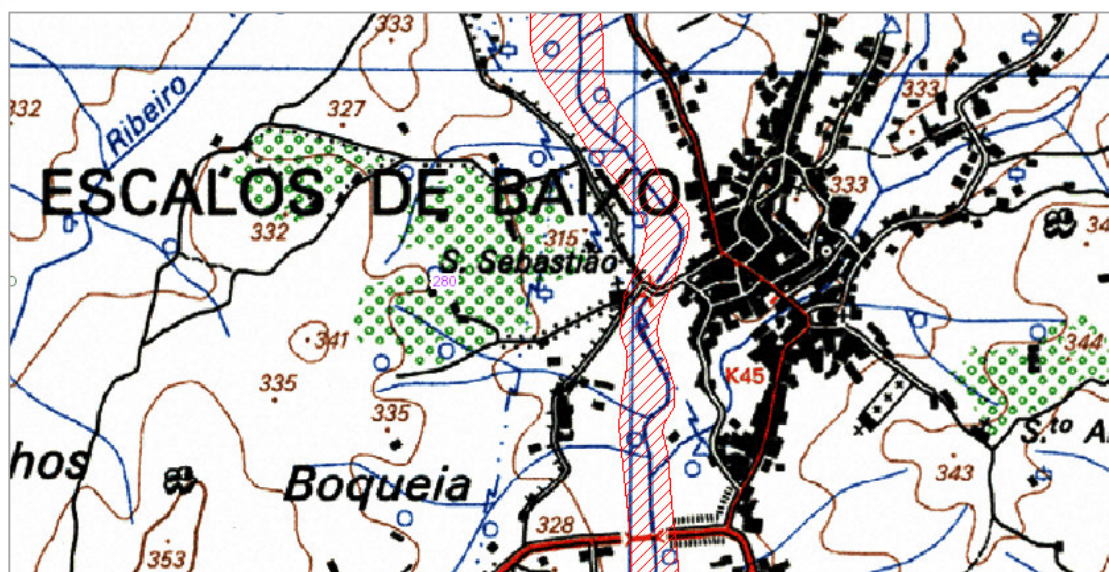
Figura 15e – Atravessamento do aglomerado urbano de Escalões de Baixo por curso de água com direção nordeste/sul, sem delimitação de ZAC e sem que este demonstre influência na sua confluência com a rib. a da Ribeirinha; Estrangulamentos na rib. a da Ribeirinha sem efeito de regolfo observável no traçado da ZAC (fls.280 da carta militar)
